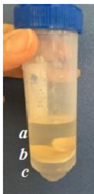
شکل ۲: تشکیل محلول سه لایه (تری فازیک) طی فرآیند استخراج پلیمر. a: لایه بالایی آب، b: لایه مرکزی بقایای سلولی و c: لایه زیرین محلول کلروفرم است
