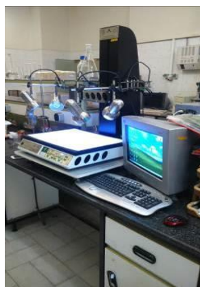
شکل ۳. مساحت‌سنجی با دستگاه WinArea-UT-10
